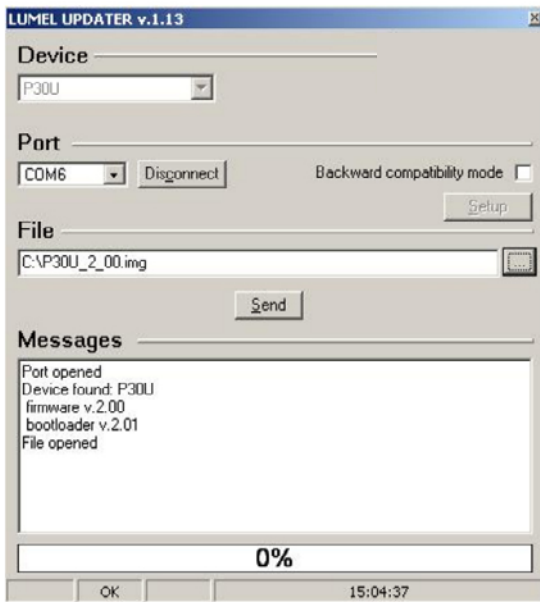
Rys.24. Widok programu do uaktualniania oprogramowania przetwornika.
